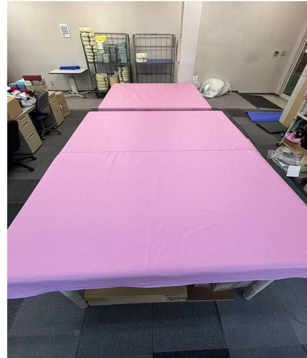
作業台のカバーを新しく製作した事で、汚れが付いたり、糸くず等があってもすぐに気がつき、その都度、清掃する事で製品を汚したり、糸くず等の混入を防ぐ事が出来るようになりました。
