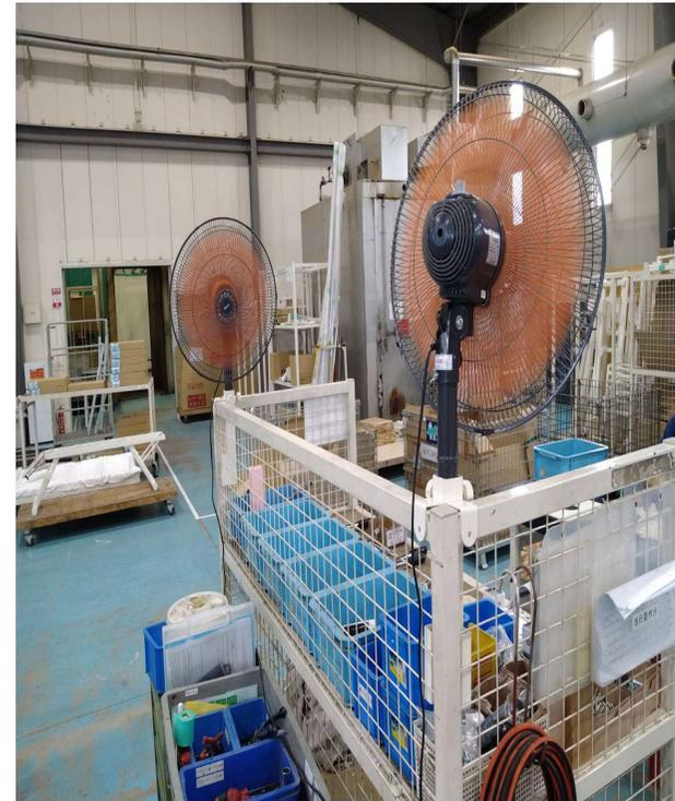
扇風機の脚部を外し部材台車に40角スチールを加工してもらい扇風機の頭だけ付ける様にしました。そうすることで通路に置かなくて良くなり作業の妨げにもならなくなりました。風も上から来るので風当たりも良好です。
